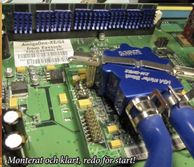
Under full last ser vi att kylblocket mäter en extern temperatur av 27,5 grader. mätt med en IR-termometer modell exklusiv.
